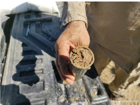
Figura 3: Muestra de arcilla obtenida a 7,00 m de profundidad.
