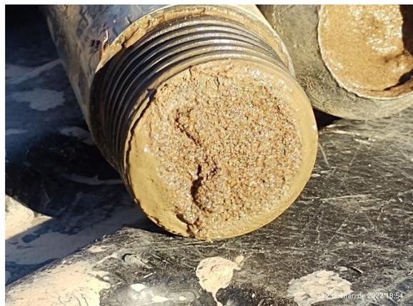
Figura 4: Muestra de arenas finas limosas extraídas a 9,00 m de profundidad.
