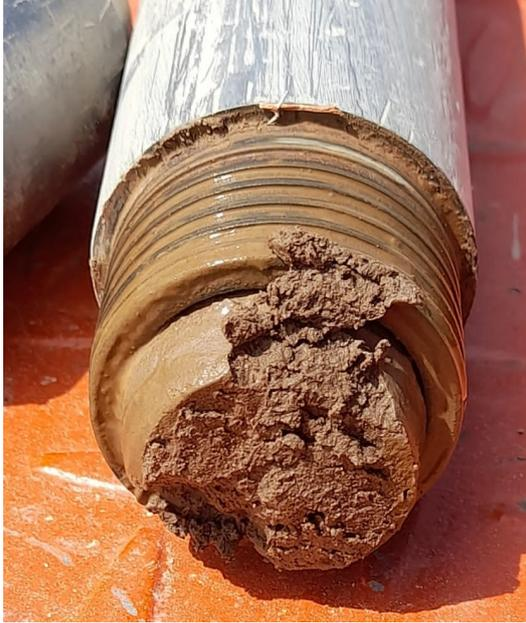
Figura 5: Muestra de arcilla extraídas a 13,00 m de profundidad.
