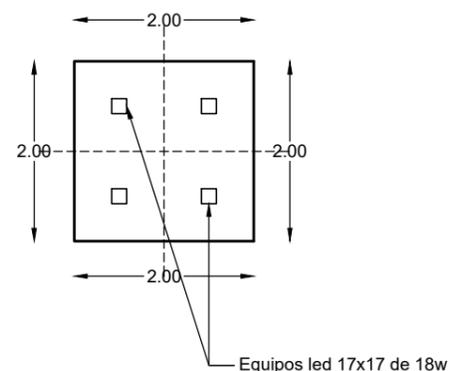
**ESQUEMA ESTRUCTURA CIELORRASO SUSPENDIDO**
